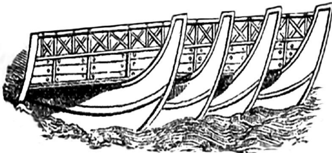
Рис. 2. Наплавной мост (понтонный).
