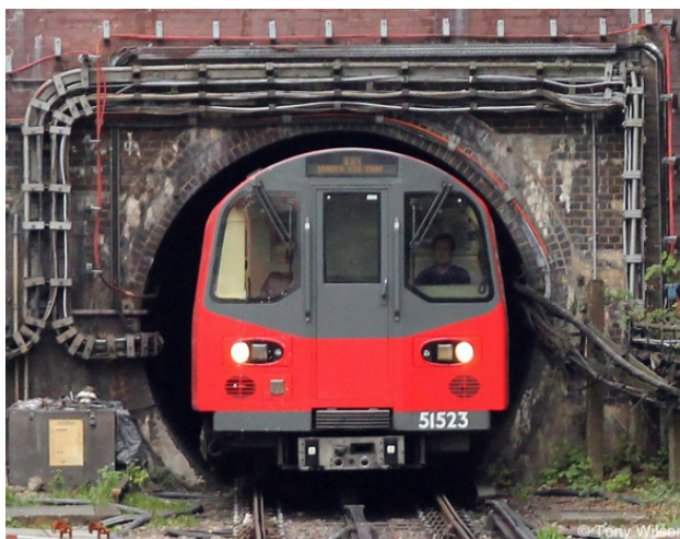
Рис.9. Вагон Лондонского метро со скошенными стенками
