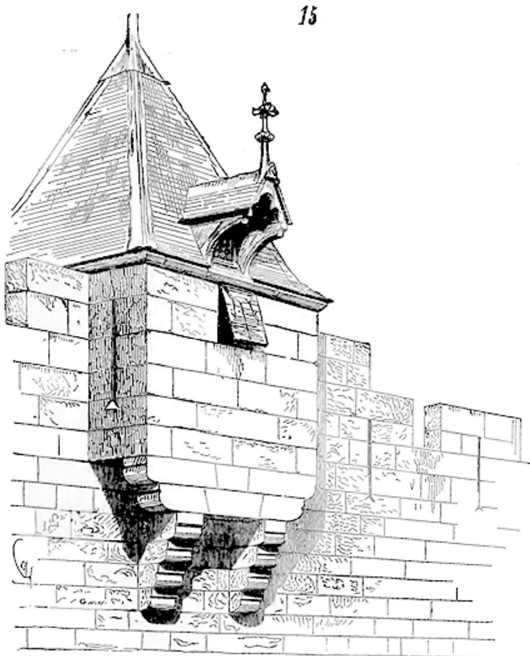
La fig. 15 donne une vue perspective extérieure de ce poste avec sa couverture. Cette construction était en granit rouge.
