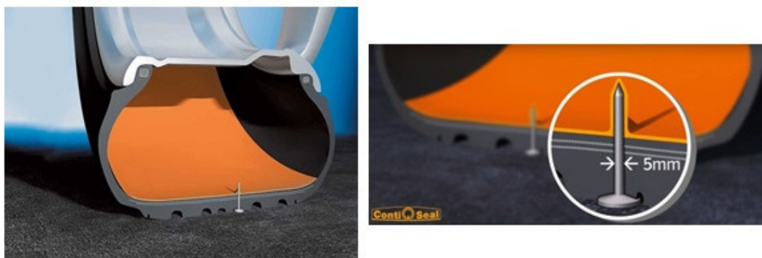
Рис. 3.3. Самозаклеивающаяся шина ContiSeal 8
