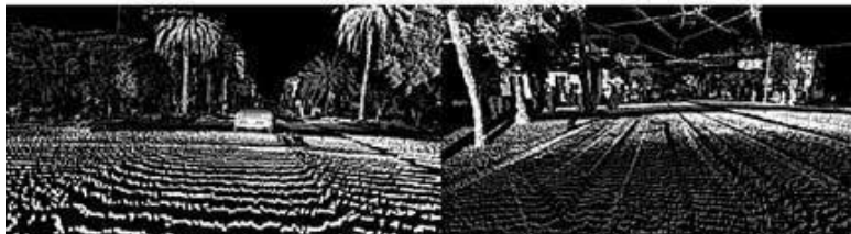
Рисунок № 2. Схематичное изображение того, как лидар реконструирует окружающую его среду
