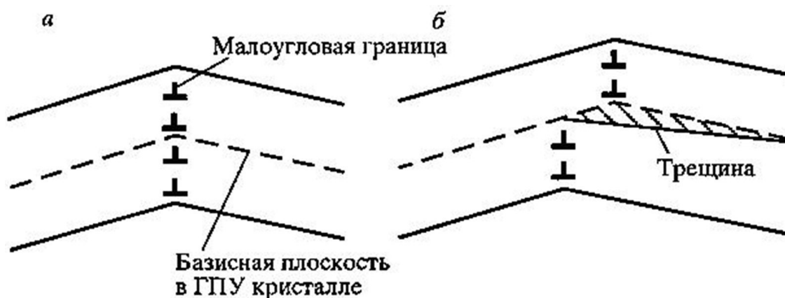
Рис. 5. Возникновение трещины при перерезании малоугловой границы: а – до деформации; б – зарождение трещины [3]
