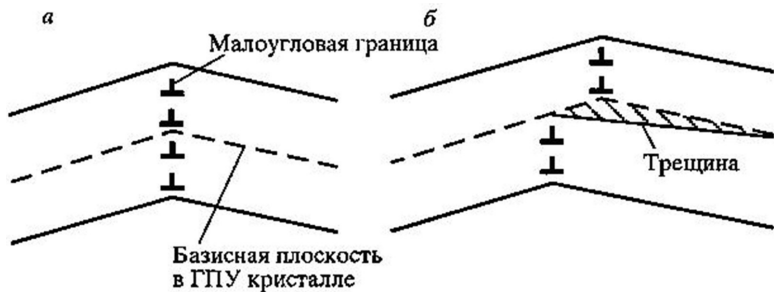
Рис. 5. Возникновение трещины при перерезании малоугловой границы:
