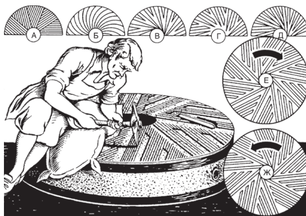
Рис. 19. Ручная обработка жерновов. На врезках – традиционные рисунки нарезки: А – конца Римской империи; В – XVIII в.; В, Г и Д – XIX в.; Е и Ж – право- и левосторонние жернова с отделкой «четыре четверти»
