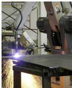
Рисунок 4. Робот для плазменной резке деталей из листового металла по заданной программе
