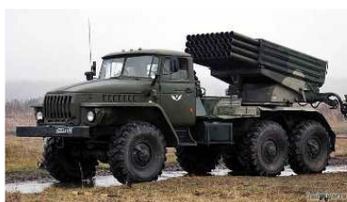
Рисунок 12. Система залпового огня БМ-21 (40 снарядов калибра 122 мм, площадь поражения – 14,5 гектар, боевой расчет – 3 человека)
