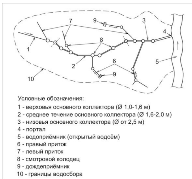
Рисунок 1. Принципиальная схема дренажной сети. Диаметры коллектора указаны для сравнения
