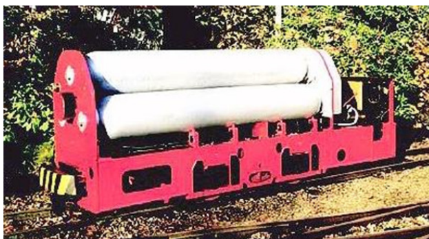
Пневматический локомотив Юнга PZ 20, построенный в 1955 г. Фото с сайта «The Self Site: Unusual Steam Locomotives».
