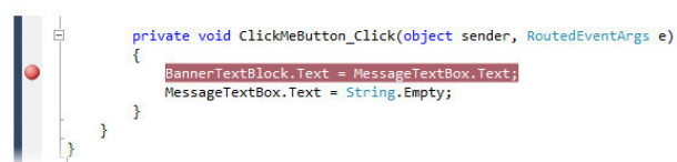
Рисунок 2.13 Установка точки останова
