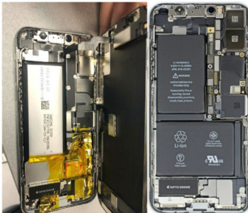
Рисунок 1 Реальный iPhone X, в корпус которого встроена аппаратная прослушка (справа)
