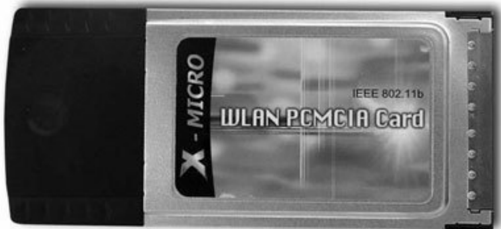
Рис. 4.7. Сетевая карта Wi-Fi, выполненная в формате PC Card
