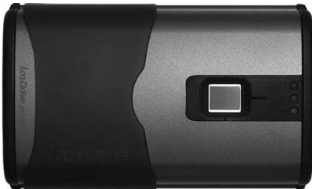
Рис. 4.11. Внешний жесткий диск формата 2,5"
