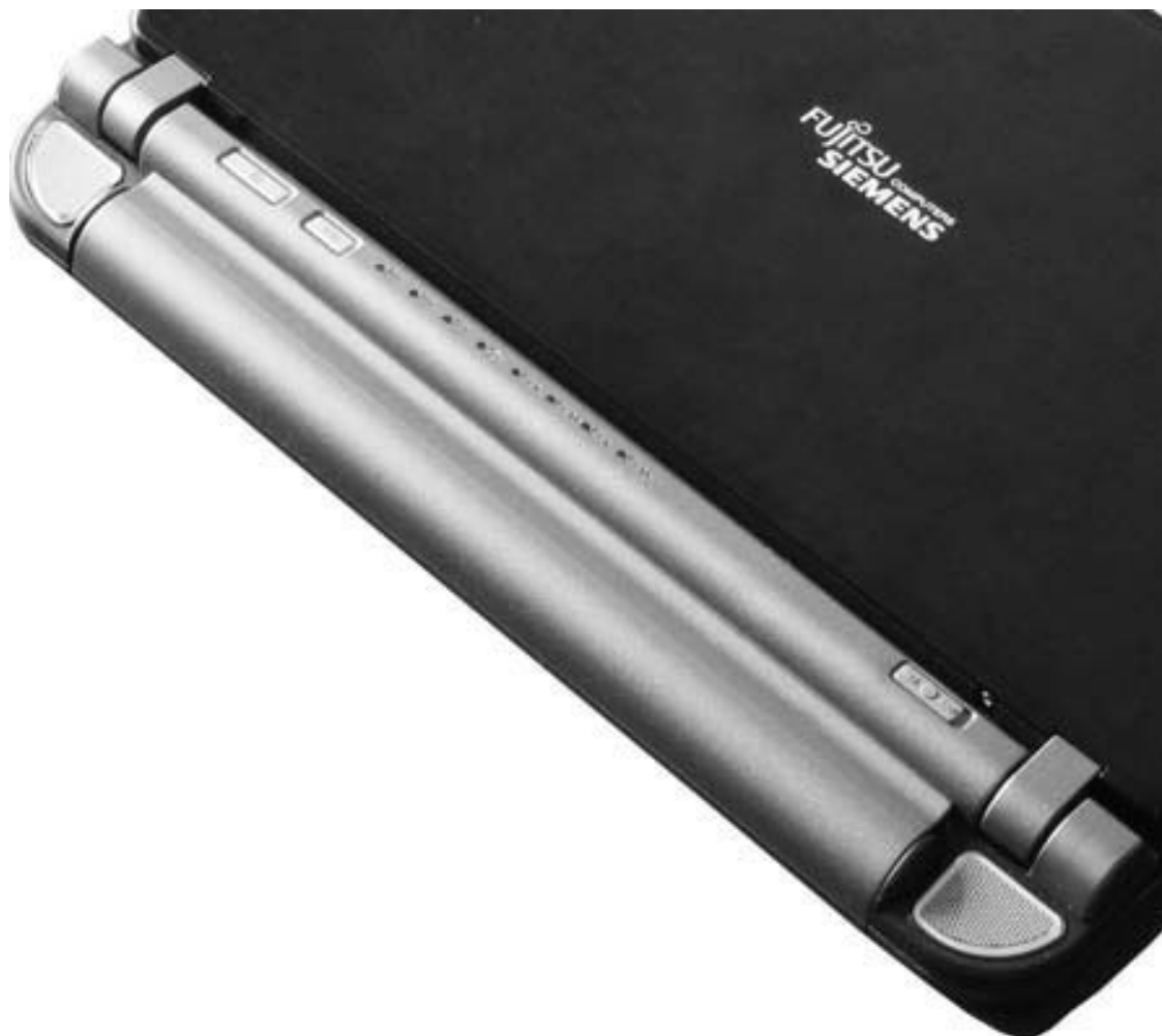
Рис. 4.4. Аккумулятор повышенной емкости
