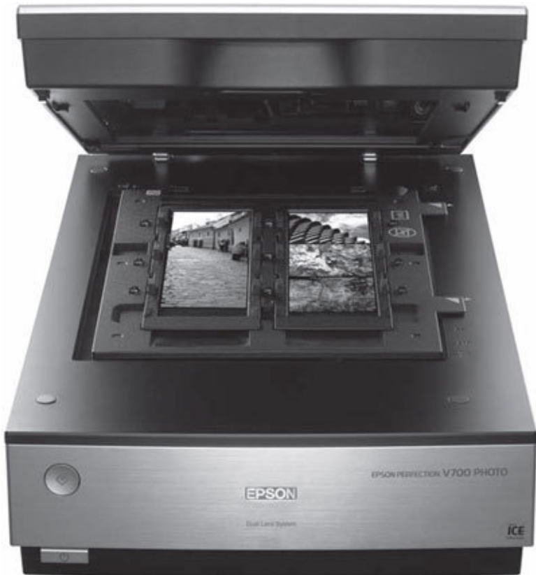
Рис. 1.2. Планшетный сканер со слайд-модулем и слайдо-держателем
