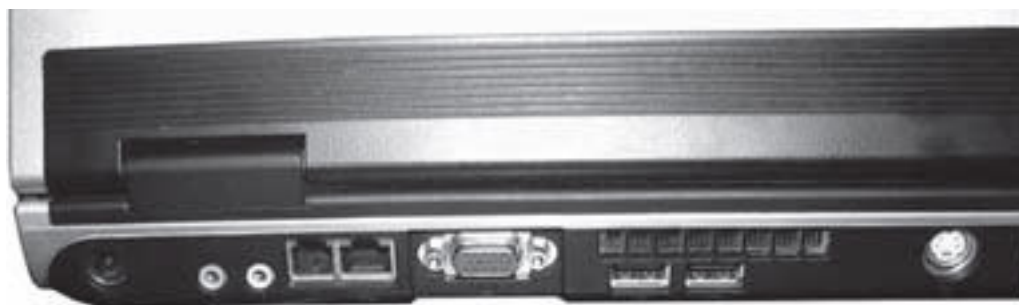
Рис. 1.2. Разъемы на заднем торце ноутбука
