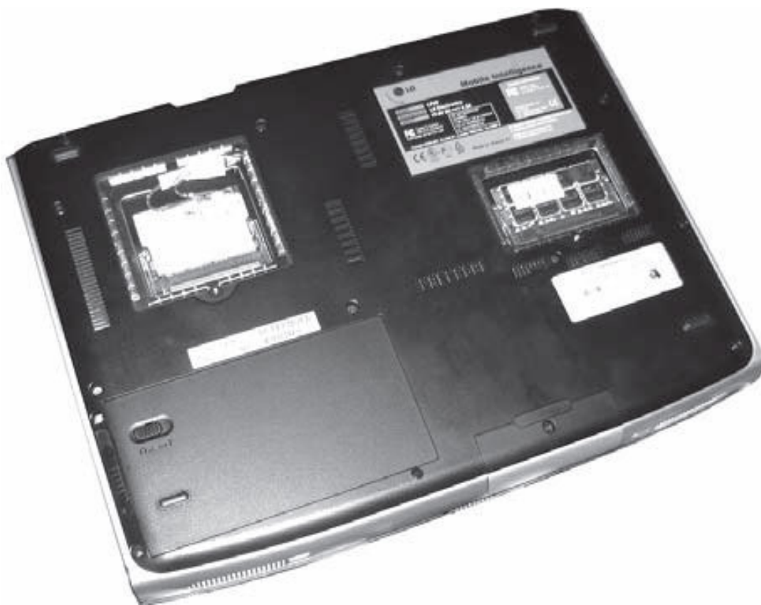
Рис. 1.3. Ноутбук снизу. Люки сняты
