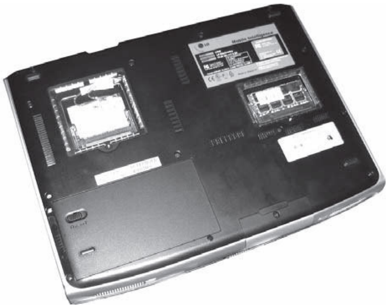
Рис. 1.3. Ноутбук снизу. Люки сняты
