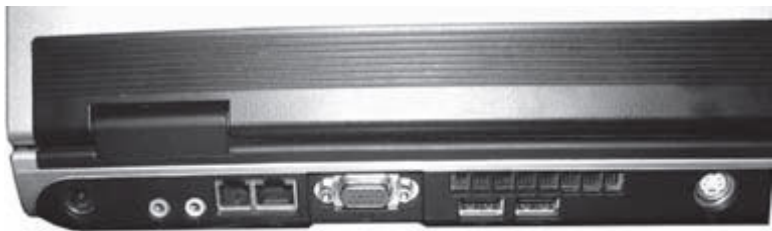
Рис. 1.2. Разъемы на заднем торце ноутбука
