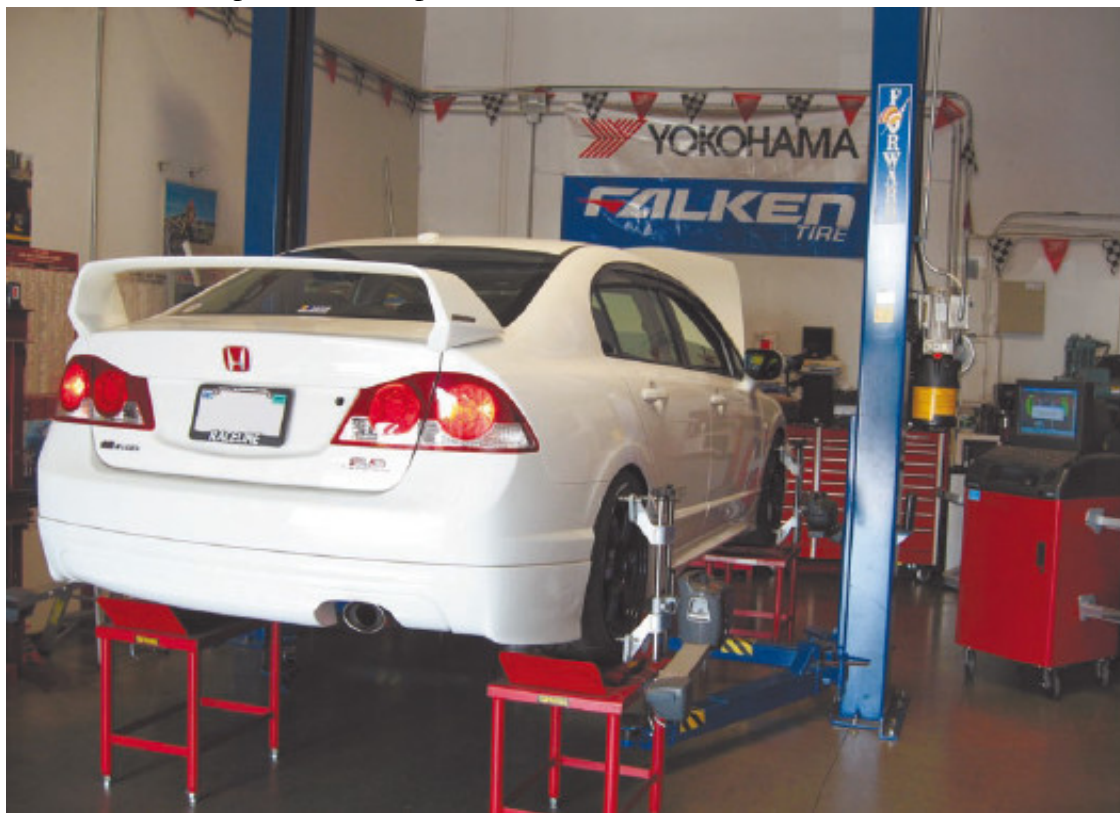
Рис. 1.12. Регулировка развала и схождения колес на СТО
