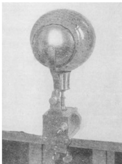
Рис 7. Электрическая машина Кулибина образца 1772 г., по [20]
