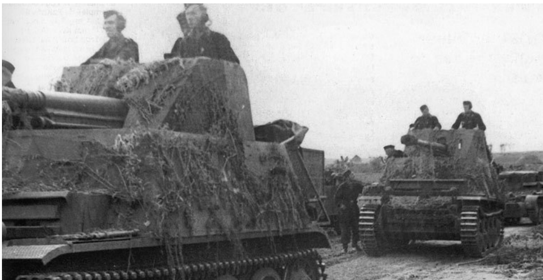
В 1942 году на вооружение противотанковых дивизионов танковых и моторизованных дивизий Вермахта начали поступать самоходные установки Marder II, вооруженные трофейной советской 76-мм пушкой Ф-22. На фото – САУ Marder II на марше
