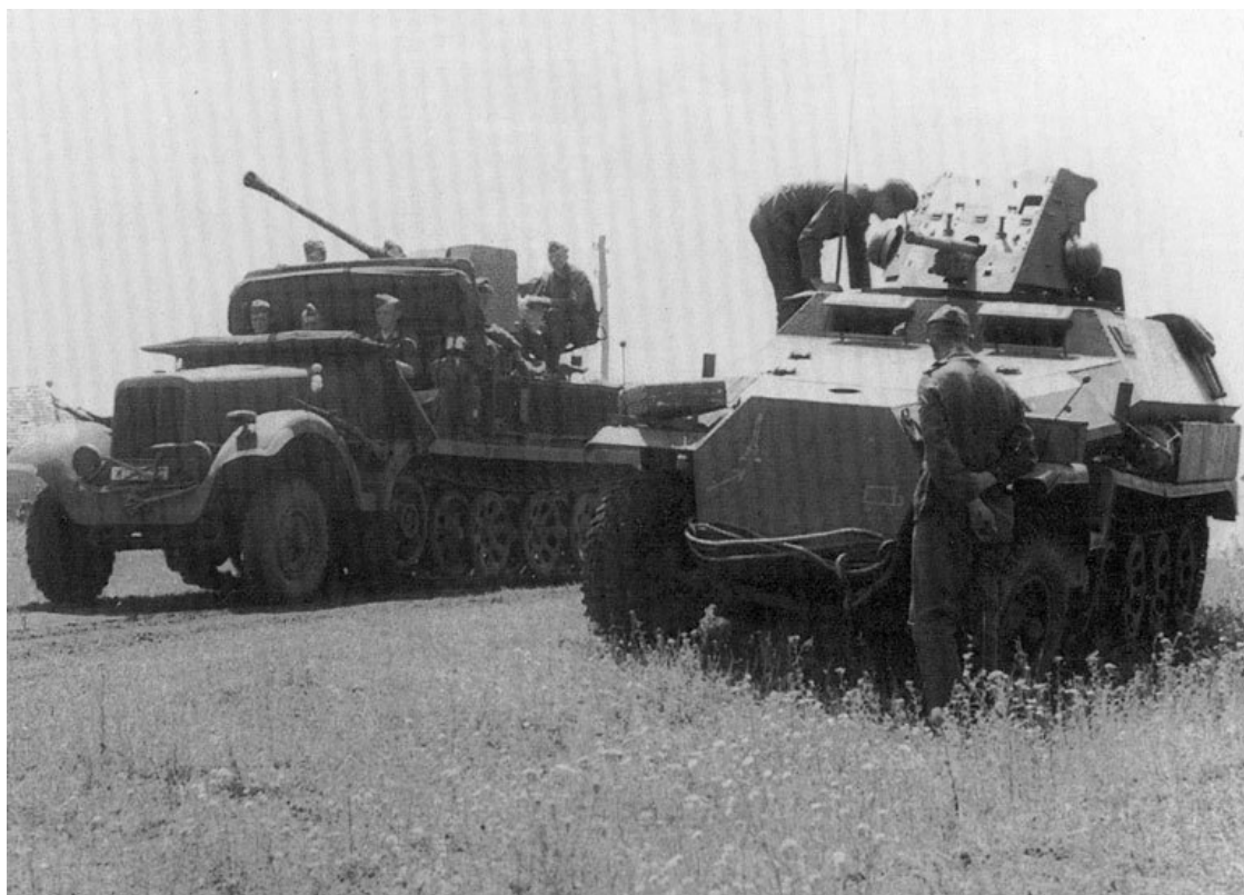
5-тонный тягач «Бюссинг-НАГ» Sd.Kfz.6 с установленной на нем 37-мм зенитной пушкой Flak 36 (слева) и бронетранспортер Sd.Kfz./10, вооруженный 37-мм противотанковой пуш-
