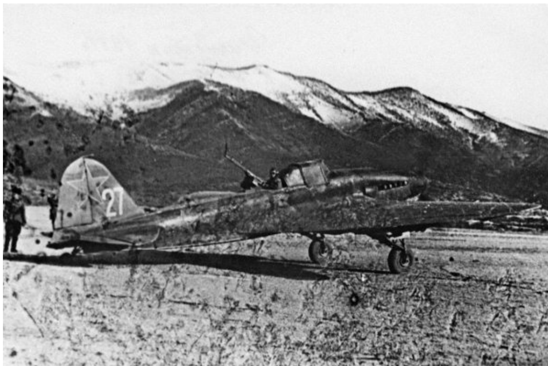
Ил-2 с самодельной оборонительной установкой под пулемет УБТ. ВВС ЧФ, 1942 г.
