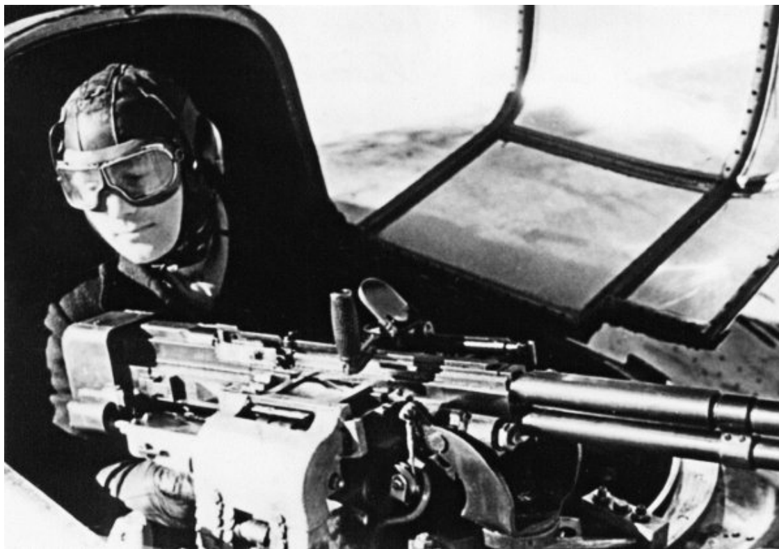
Установка пулемета УБТ на серийном самолете Ил-2. Воздушный стрелок старшина И.А. Сучков, Калининский фронт, март 1943 г.
