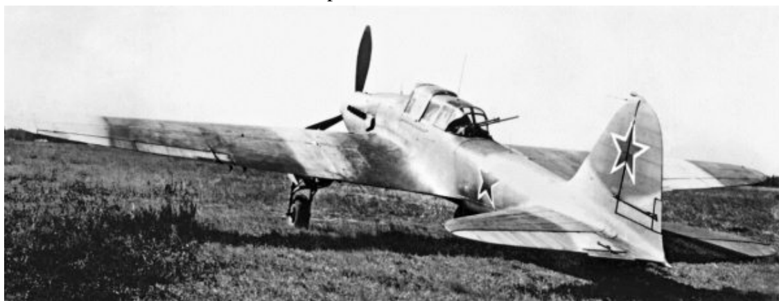
Ил-2 АМ-38ф с 20-мм пушкой УБ-20 на турели ВУБ-3. Государственные испытания, август 1944 г.
