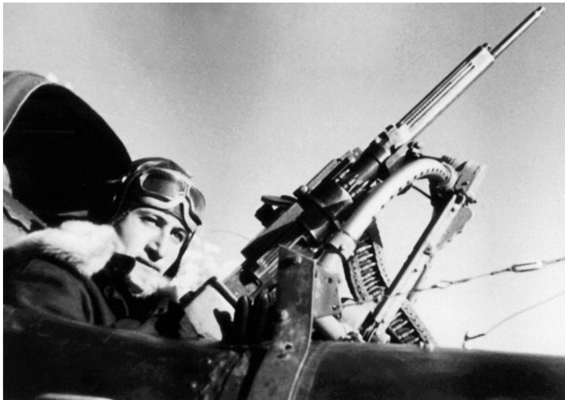
Воздушный стрелок Ил-2 сержант Баклар Саакян за самодельной оборонительной установкой под пулемет ШКАС
