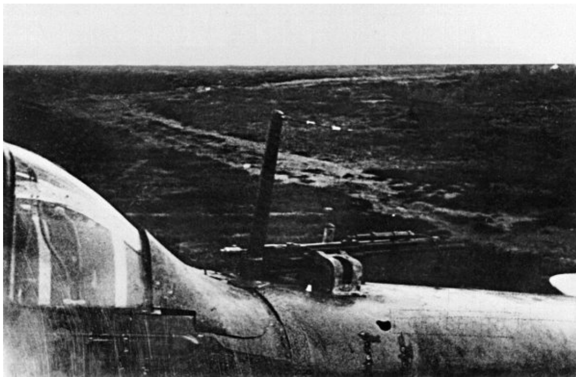
Ил-2 АМ-38 (зав. № 2514) производства завода № 18 с одним неподвижным пулеметом УБ для стрельбы назад. Государственные испытания, февраль 1942 г.
