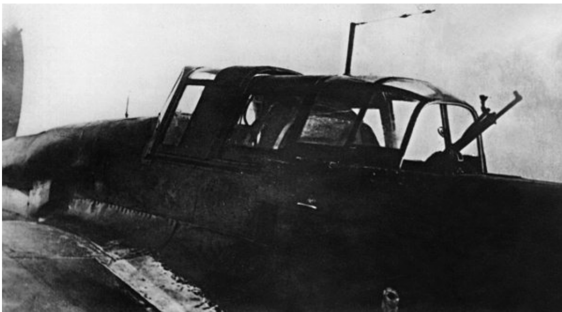
Двухместный Ил-2 АМ-38 (зав. № 897) с пулеметом ЛЛ1КАС на турели производства завода № 30. Государственные испытания, октябрь 1942 г.
