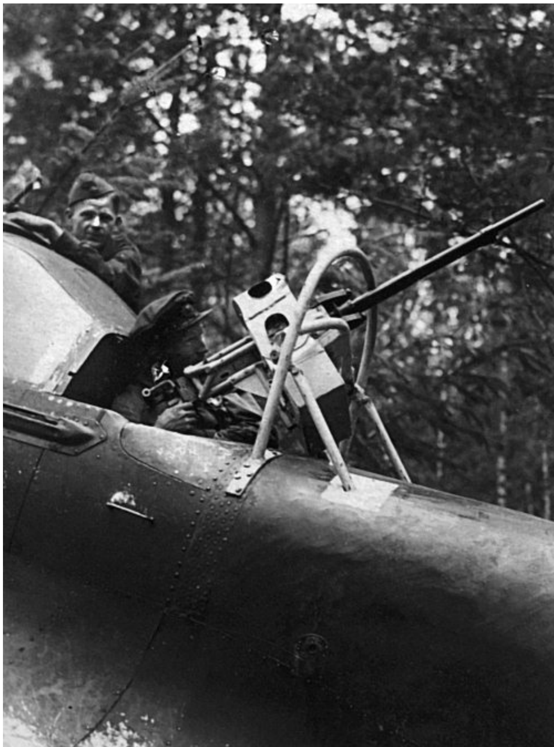
Установка оборонительного пулемета УБТ на самолете Ил-2, смонтированная силами технического состава 243 шад 6 ВА в августе 1942 г.
