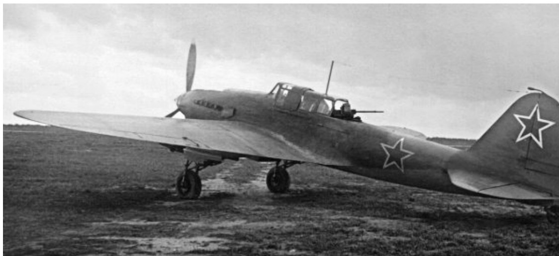
Ил-2 АМ-38ф с турельной установкой УБШ конструкции завода № 487 НКАП под пулемет УБТ. Государственные испытания, июнь 1944 г.
