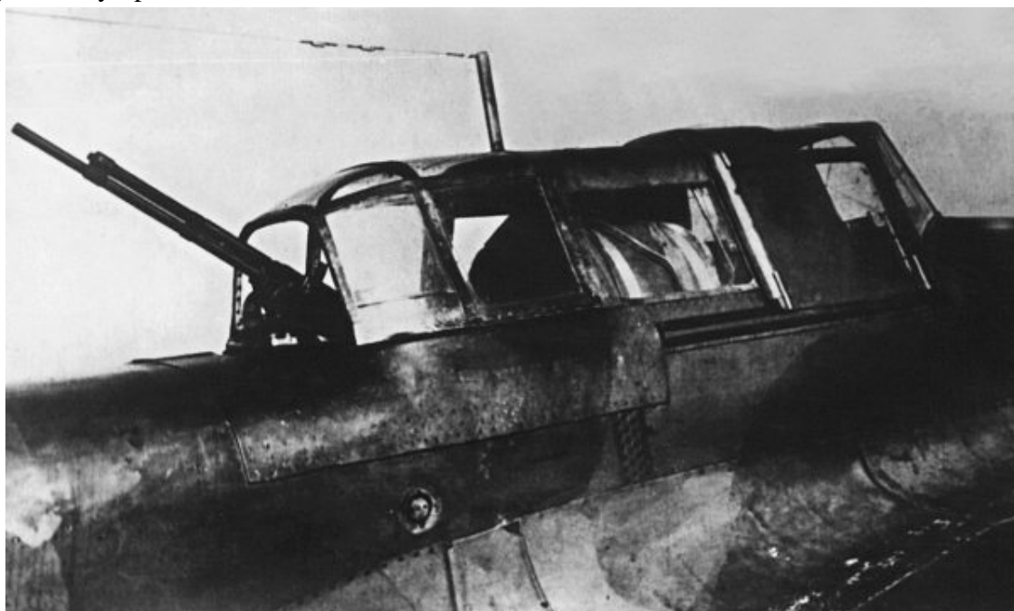
Двухместный Ил-2 АМ-38 (зав. № 887) с пулеметом УБТна турели производства завода № 30. Го су дарственные испытания, октябрь 1942 г.
