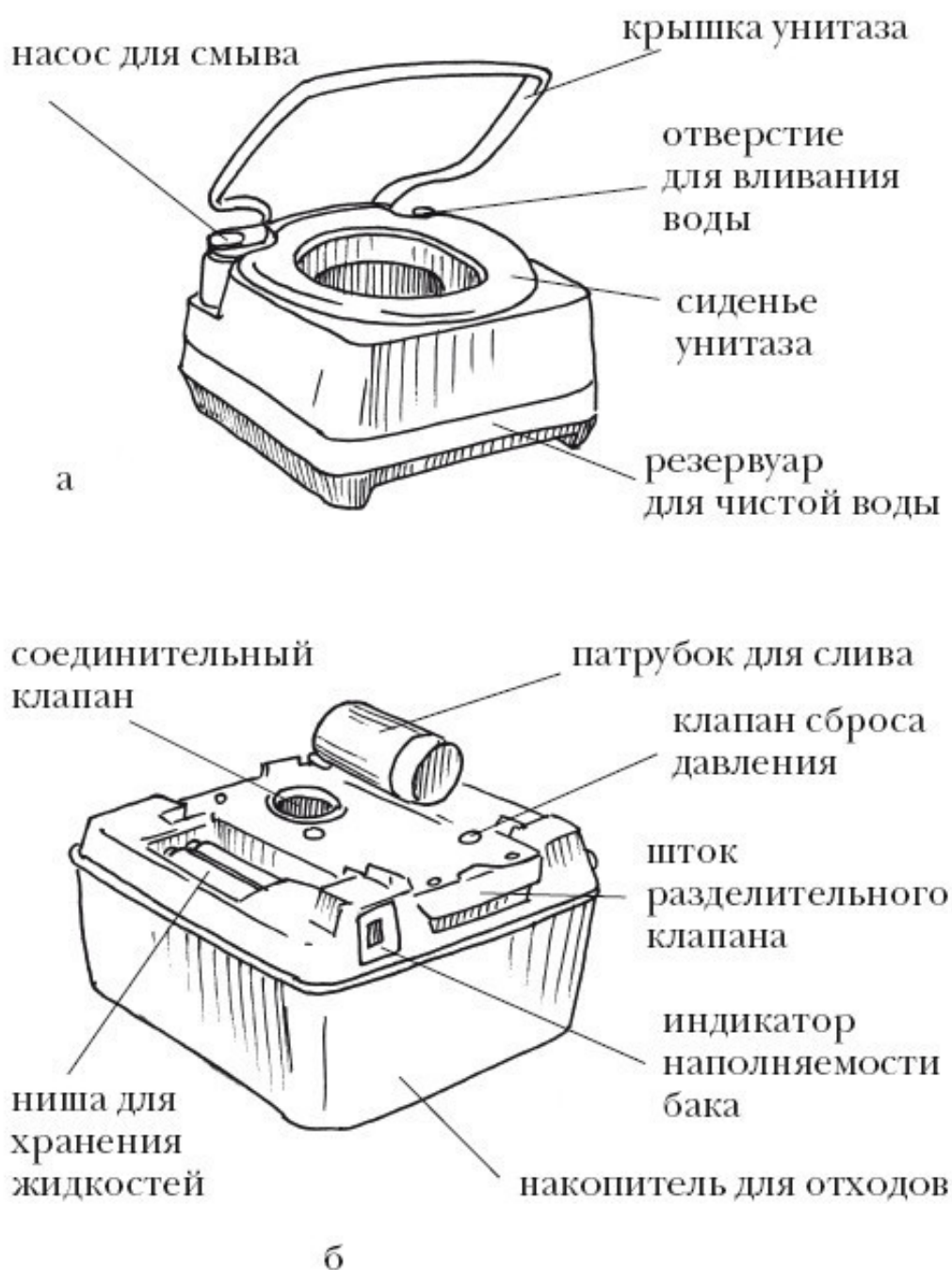
Рисунок 2. Химический биотуалет: а) верхняя емкость; б) нижняя емкость
