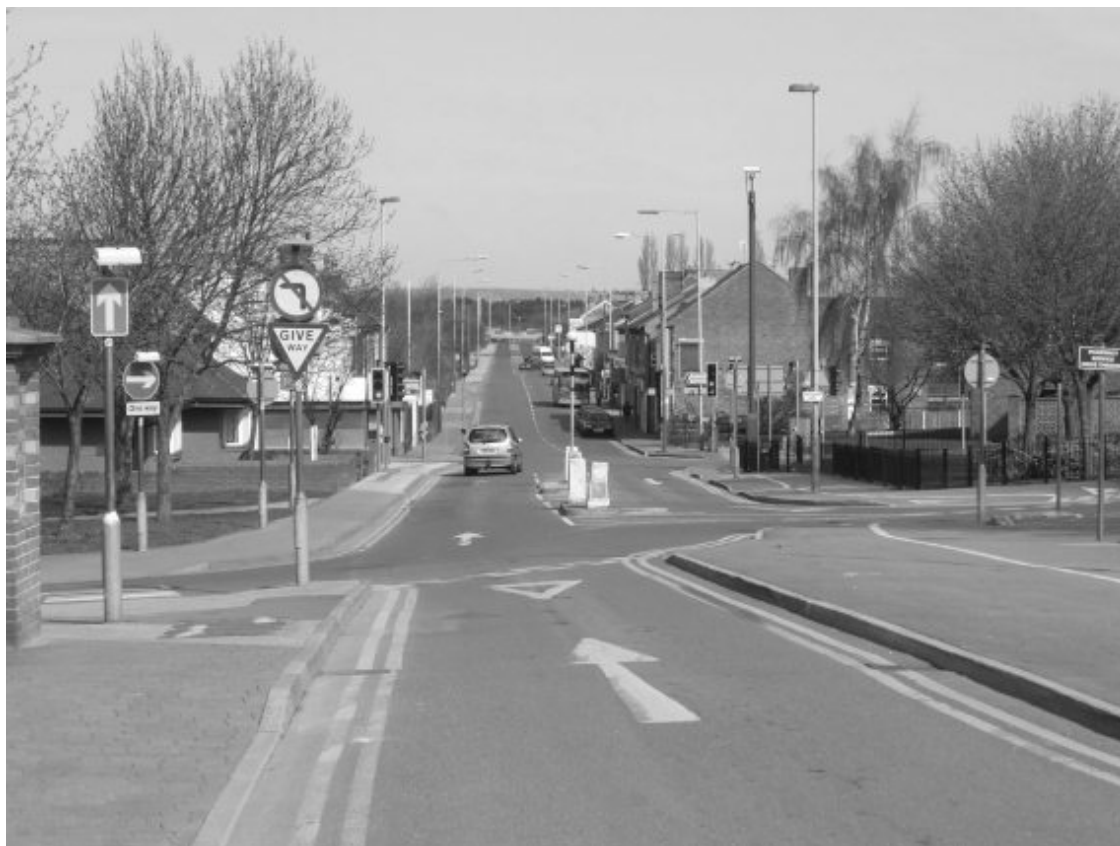
Рис. 1.1. Дорожные знаки, разметка и светофоры – технические средства регулирования дорожного движения
