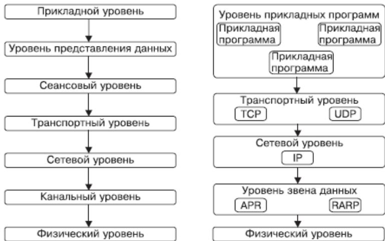
Рис. 3.3. Распределение протоколов стека TCP/IP по уровням модели ISO/OSI
