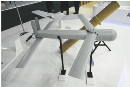
Фото 15. БПЛА CN-901. Длина 1200мм, масса 9кг. Максимальная скорость-до 150км/ч, дальность действия 15км. (Фото с vrk.name )
