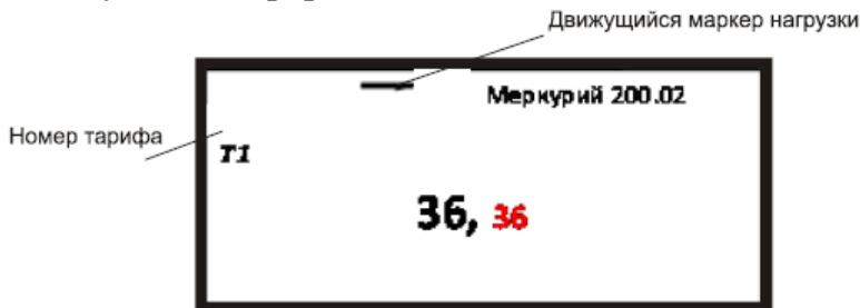
Рис. 1.21. Показания на дисплее электросчетчика "Меркурий 200.02"
