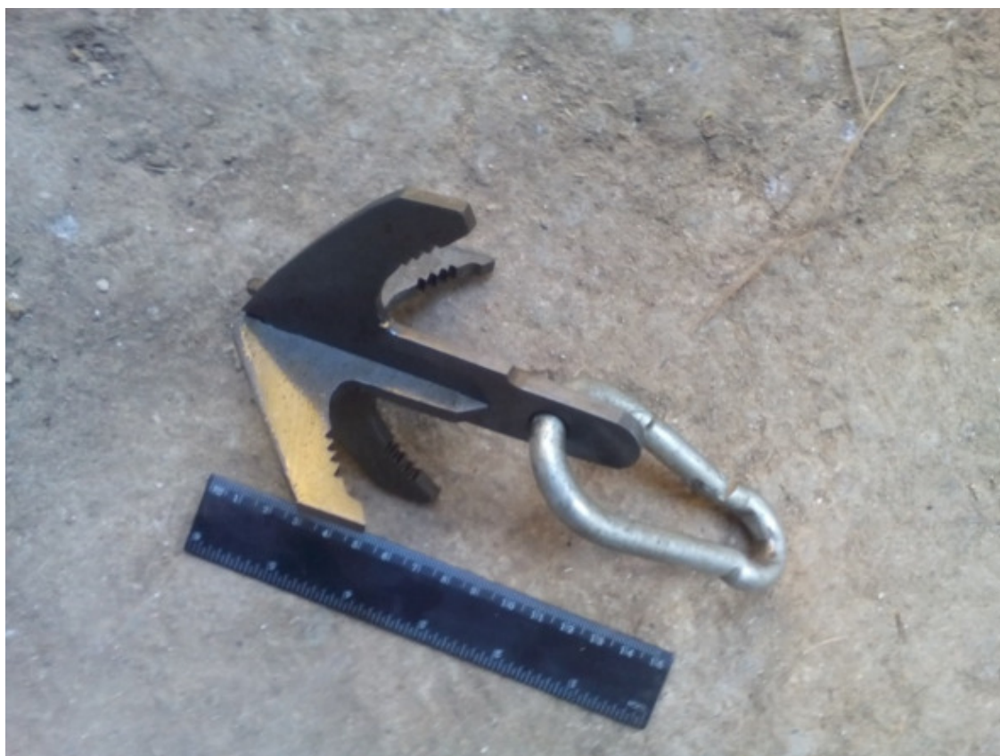
Фото 64. Разборная кошка-якорь. Изготовлена автором.
