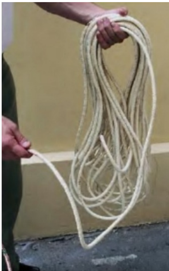
Фото 52. Укладывание («бухтование») верёвки.
