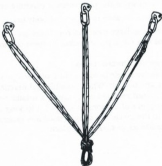
Фото 42. Организация станции на трёх точках при помощи шлямбурных крючьев.
