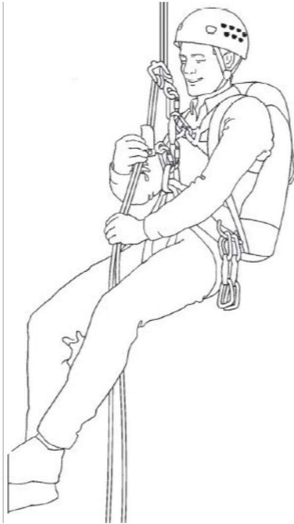
Рисунок 33. Положение альпиниста на двойной верёвке, с поясной и грудной обвязками. Заметны спусковое устройство типа «восьмёрка», страхующий зажим типа «шант» (кулачковый зажим для двойной верёвки).
