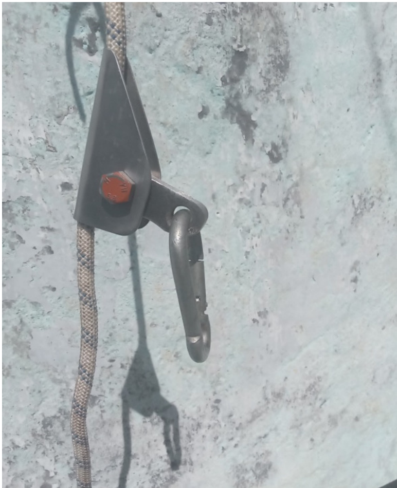
Фото 34. Зажим типа «гиббс», изготовленный и используемый автором книги
