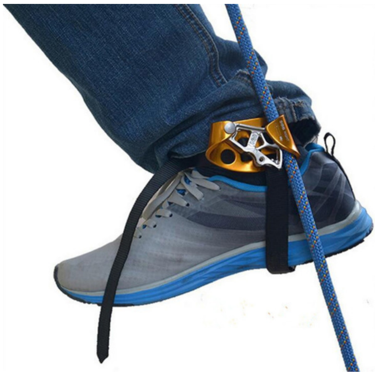
Фото 46. Крепление зажима к ноге для подъёма по верёв-
