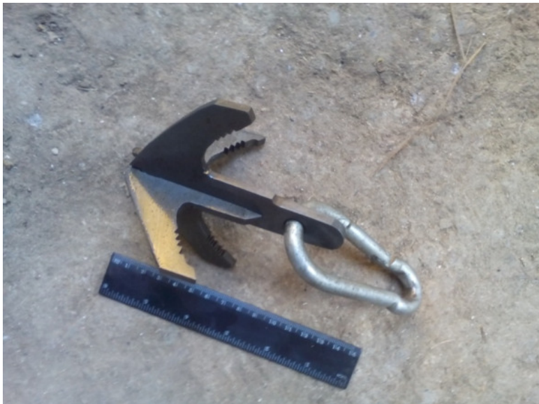
Фото 64. Разборная кошка-якорь. Изготовлена автором.
