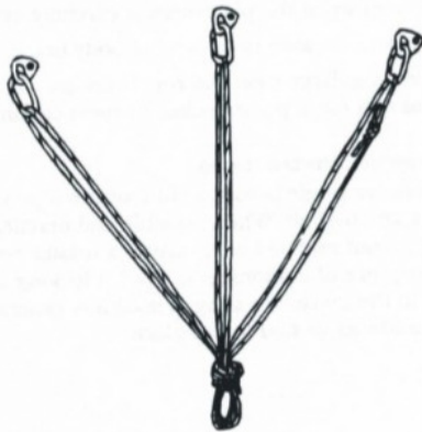
Фото 42. Организация станции на трёх точках при помощи шлямбурных крючьев.
