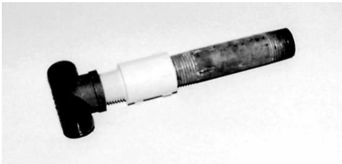
Рис. 2.6. Пластиковый переходник между медной и стальной трубами предотвратит возникновение пробки в результате электролитической реакции
