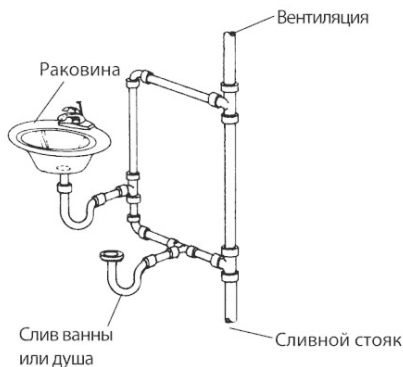
Рис. 1.9. Стандартные многотрубные соединения
