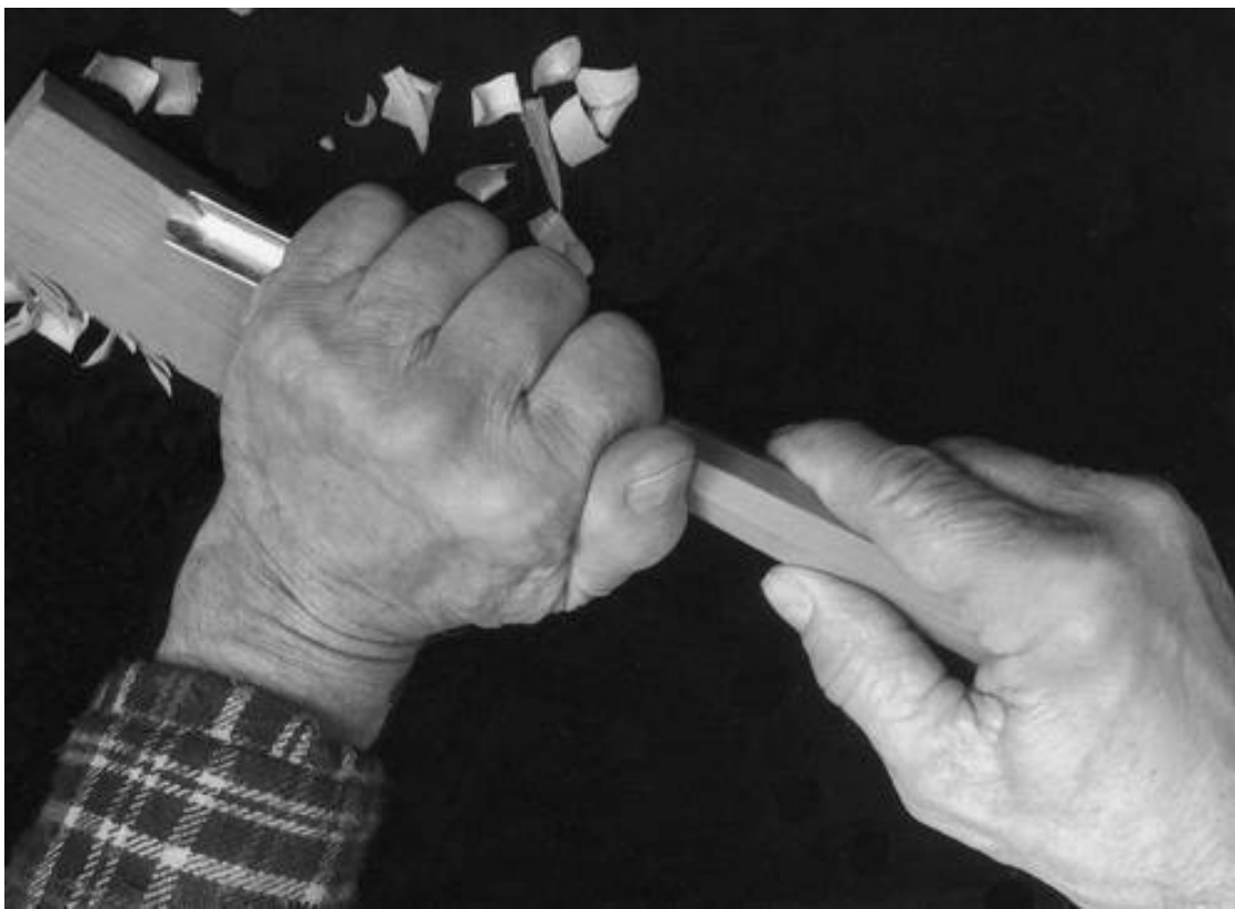
Фото 14. Третий способ держания овальной стамески – двумя руками
