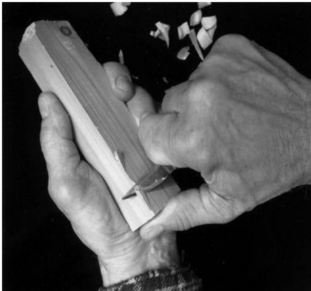
Фото 8, 9. Два приема держания ножа
