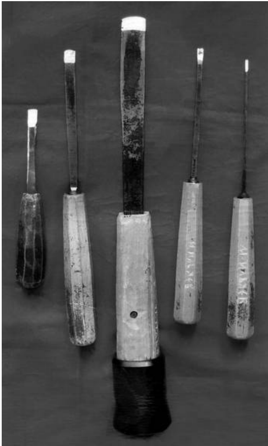
Фото 10. Плоские стамески. В центре резиновый наконечник от костылей, сохраняет ручку от удара киянкой, убавляя шум, что желательно в домашней обстановке
