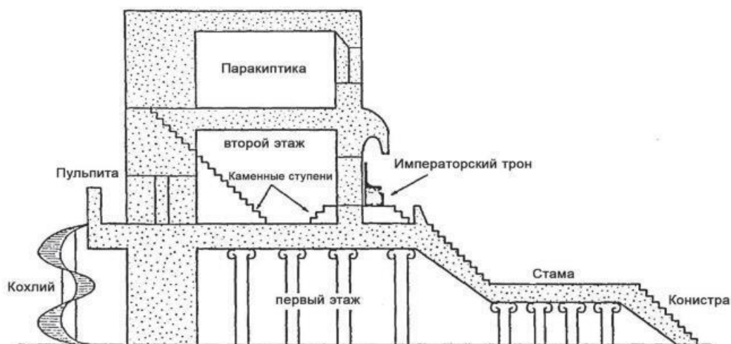
Рис. ЧЗ. План императорской трибуны (кафисмы) (по С. Гиацису, В. В. Хапаеву, А. М. Глушичу)
