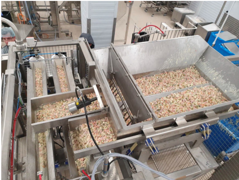
Оборудование для автоматического дозирования салата в индивидуальную упаковку
