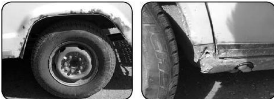
Рис. 1.5. Наиболее подверженные коррозии участки автомобиля: а – колесные арки; б – молдинги и декоративные накладки
