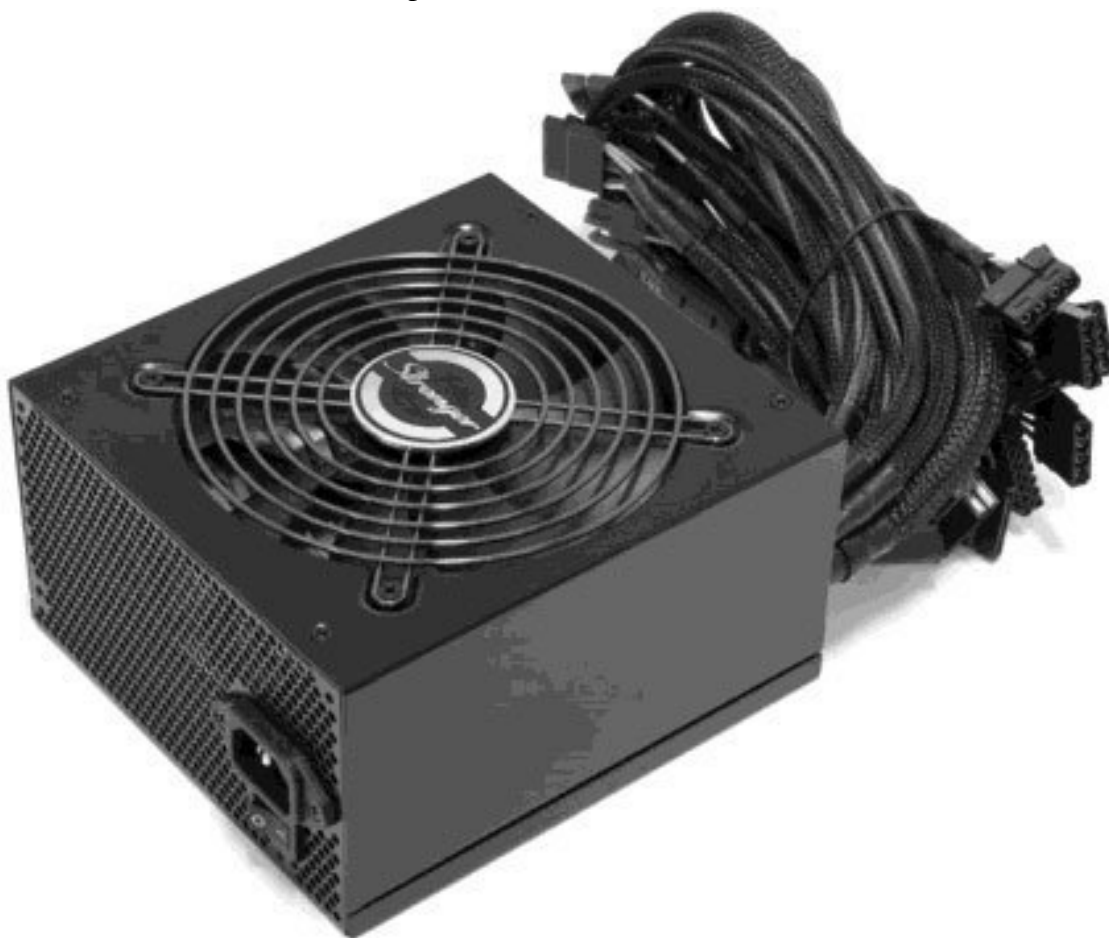
Рис. 1.4. Пример блока питания с вентилятором 120 мм
