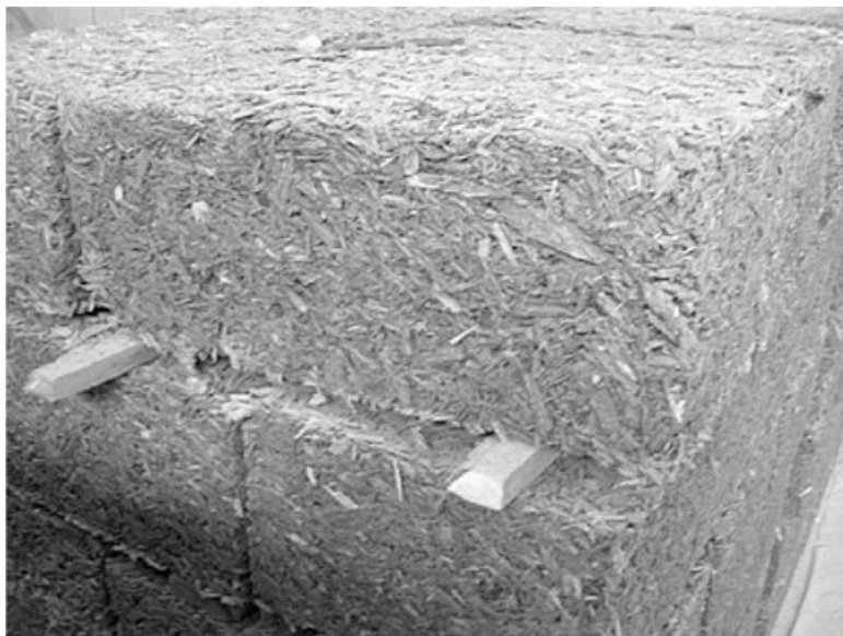
Рис. 1.5. Легкий бетон на древесном заполнителе
