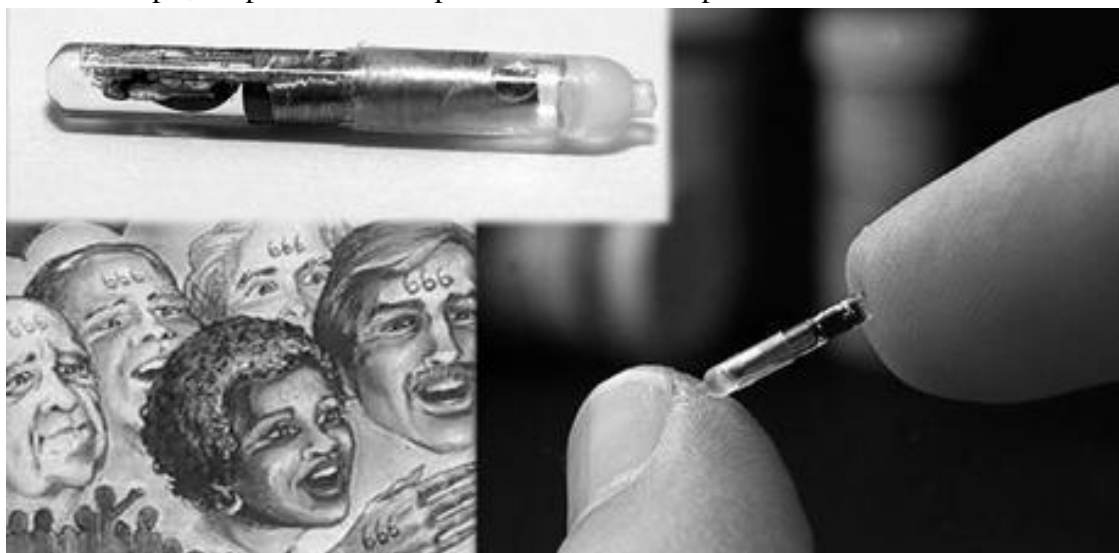
VeriChip, подкожная капсула с микросхемой RFID
