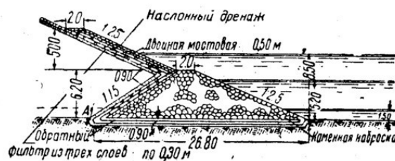
Рис. 5.2.4. Дренажная призма из камня с наклонным дренажем [2].
