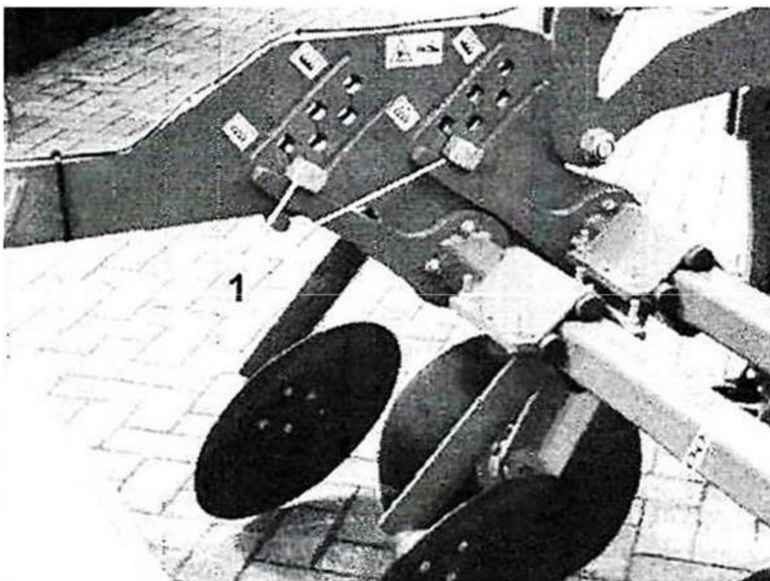
Рисунок 2.6 – Регулятор глубины сферических дисков: 1 – эксцентриковый палец
