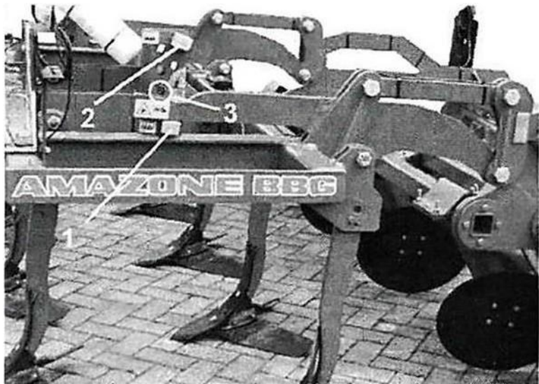
Рисунок 2.7 – Регулятор глубины лап: 1, 2 – эксцентриковые пальцы; 3 – рычаг катка
