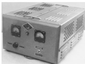
Рис. 1. Блок автоматического регулирования напряжения АРН (МТЗ)
