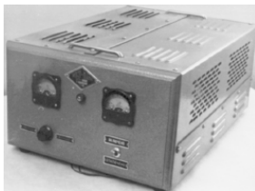
Рис. 1. Блок автоматического регулирования напряжения АРН (МТЗ)
