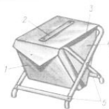
Рис. 14. Рыболовный стул-сумка конструкции С. Подвального: 1 – карман для зимних удочек, 2 – ручка; 3 – «вход» в сумку; 4 – сумка; 5 – перемишки.
