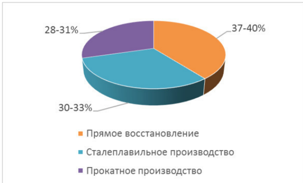
Рисунок 1.5 – Структура потребления энергетических ресурсов на заводе с установками прямого восстановления железа
