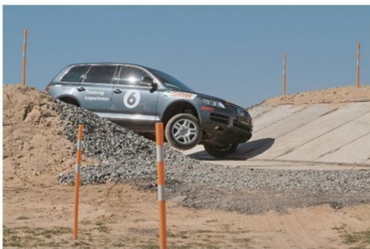
Диагональное вывешивание — жестокое испытание на надежность
