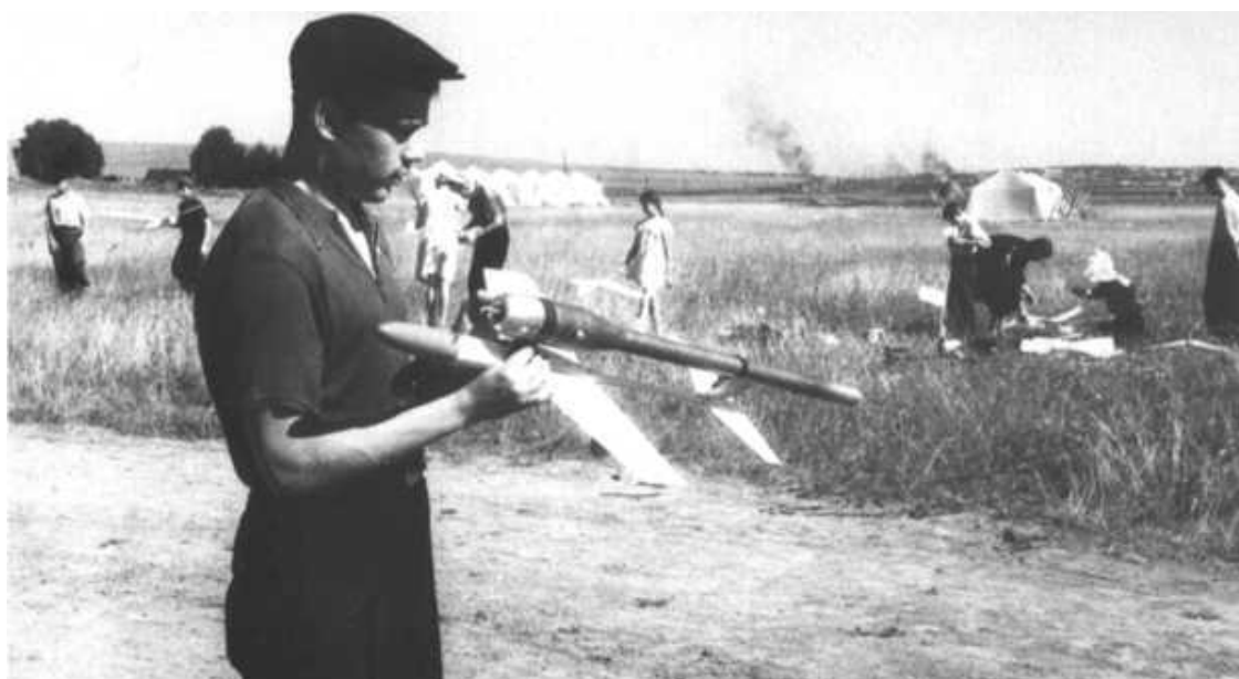
26. Авиамодель с пульсирующим реактивным двигателем перед пуском.
